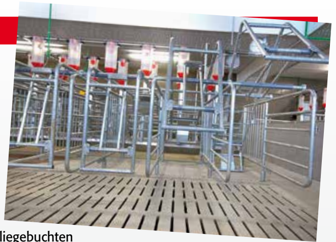
Sauenfressliegebuchten mit Selbstfangwippen für Gruppenhaltung
